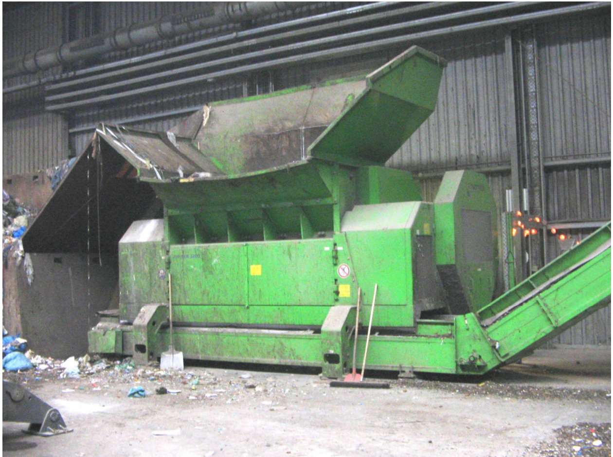
Abbildung 4: Neuer Vorzerkleinerer in Stralsund
