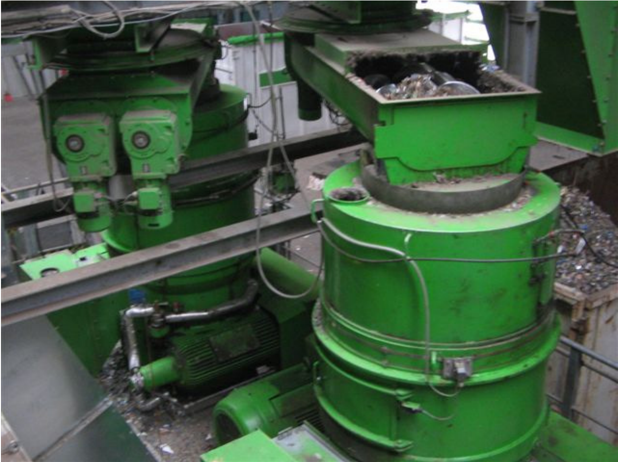
Abbildung 7: Pelletierpressen mit Förder- und Dosierschnecken
