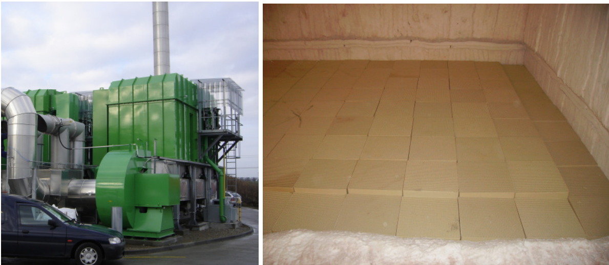
Abbildung 9: RTO in Stralsund und zusätzliche Schicht Wabensteine
