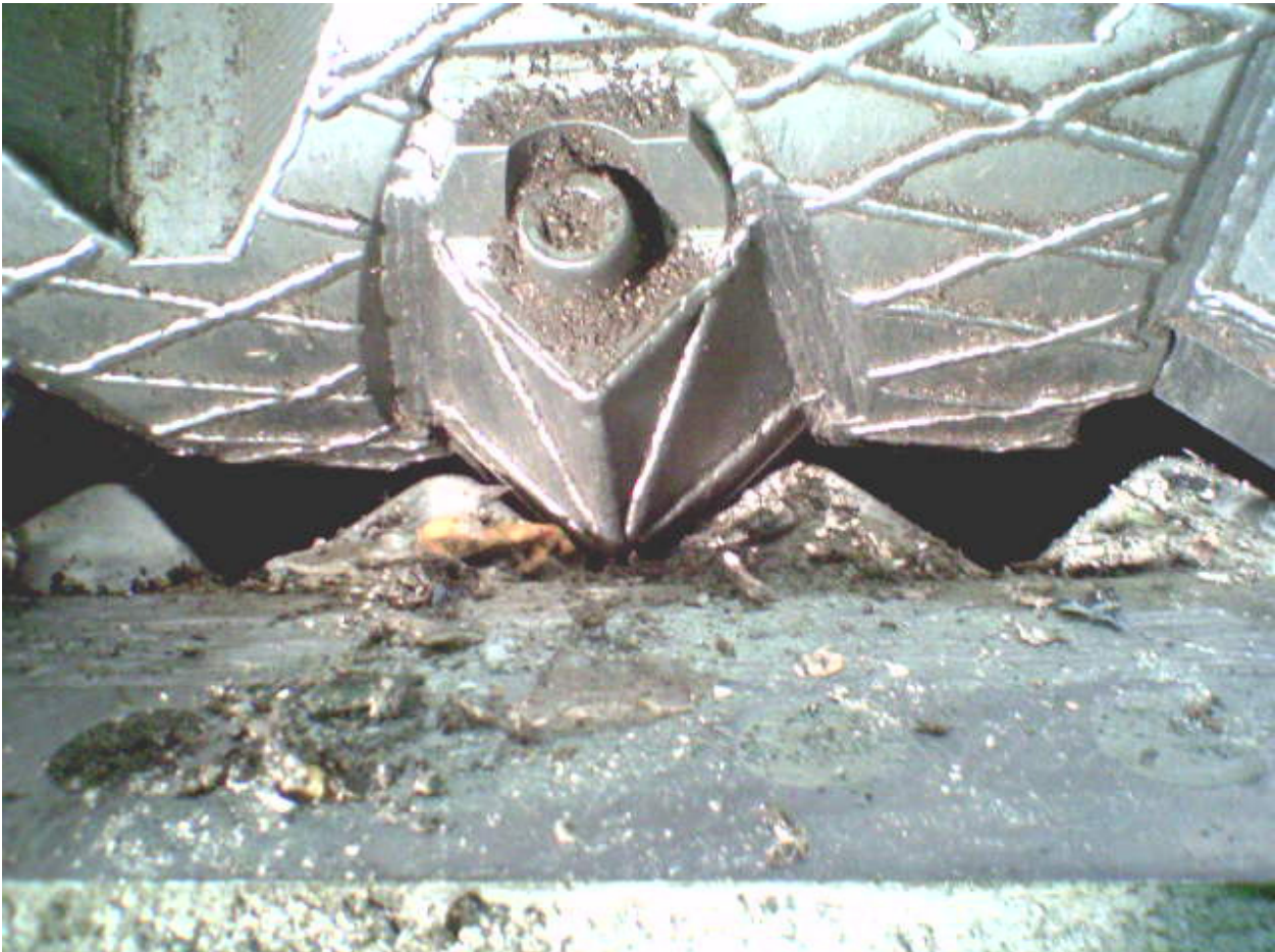
Abbildung 5: Schnittvorgang Rotormesser im Gegenmesser
