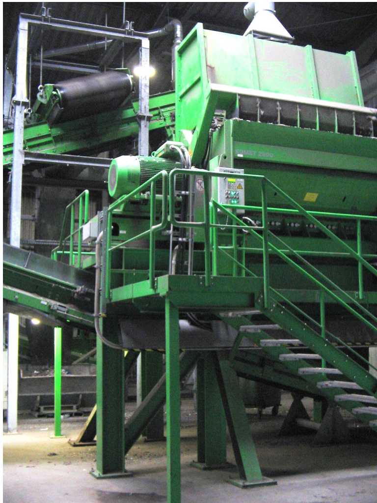
Abbildung 6: Neuer Nachzerkleinerer mit zusätzlichem Magnetscheider in Stralsund
